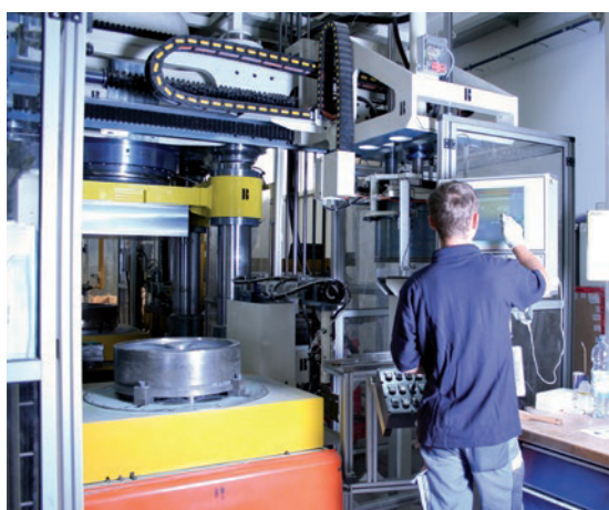
采用 CNC 路径控制压机，让每个砂轮拥有均匀的结构。
