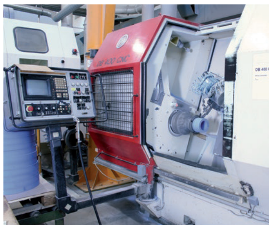
用 CNC 控制车床进行精确的最后加工。
