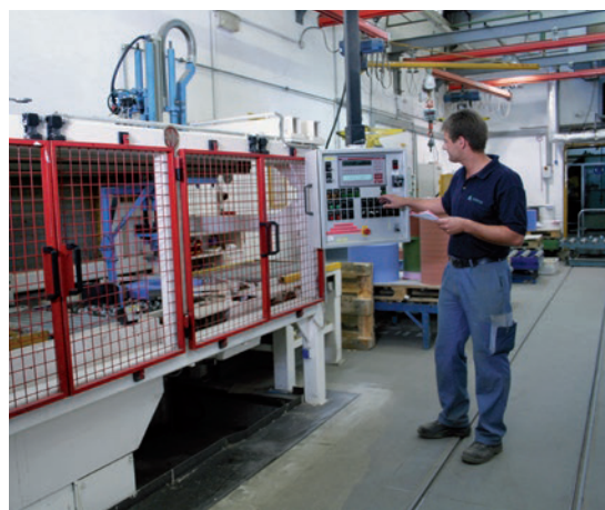
计算机控制的试验机进行不平衡度检查和试运行速度测试。
