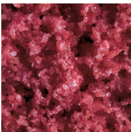
57A46 H18VPHHGG900W 含有大气孔、具有最高材料去除率的高气孔率结构；主要用于航空工业中难以磨削的零件
