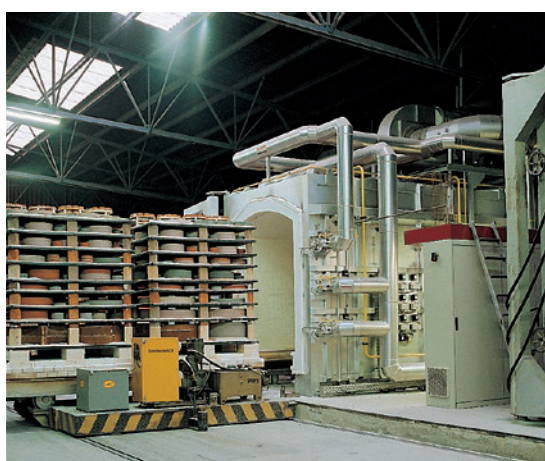
配备烧成曲线电子控制系统的炉子，让质量稳定且有据可查。
